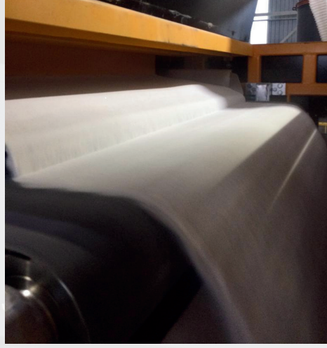
Roll Manyetik Seperatörde ki Malzeme Akışı (Material Flow in Roll Magnetic Separator)
