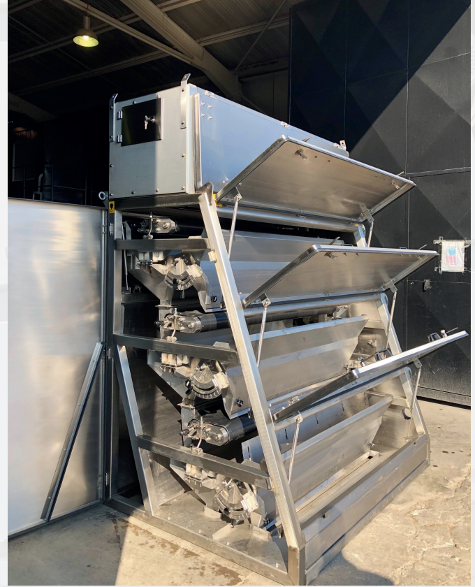
Roll manyetik seperatör paslanmaz çelik şeklinde imalatı (Manufacture of roll magnetic separator in stainless steel)
